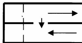
Простейший датчик движения представляет собой два куска волновода (скажем  $23 \times 10$ ), сложенные вдоль узкой стенки. С одной стороны, волноводы закорочены и с помощью диафрагм в них организованы резонаторы, настроенные на частоту  $F_0$ . СВЧ мощность излучается (попадает) в резонаторы через отверстие связи в диафрагме. В одном резонаторе помещен диод Ганна (G) (или лавинно пролетный диод – ЛПД).
