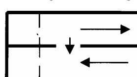
Простейший датчик движения представляет собой два куска волновода (скажем  $23 \times 10$ ), сложенные вдоль узкой стенки. С одной стороны, волноводы закорочены и с помощью диафрагм в них организованы резонаторы, настроенные на частоту  $F_0$ . СВЧ мощность излучается (попадает) в резонаторы через отверстие связи в диафрагме. В одном резонаторе помещен диод Ганна (G) (или лавинно пролетный диод – ЛПД).
