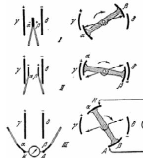
Индукционные машины, предназначенные для практического применения, имеют еще одно добавочное устройство, которое доводит заряд на пластинах  $\gamma$  и  $\delta$  до очень высокого значения и обеспечивает его сохранение, несмотря на неизбежные потери вследствие плохой изоляции. Для осуществления такого добавочного устройства были предложены два процесса.
